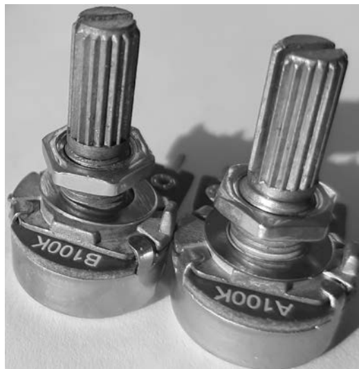
Rysunek 4.9. Potencjometry o wartości nominalnej 100 k \Omega oraz charakterystykach: liniowej (po lewej) i logarytmicznej (po prawej)
