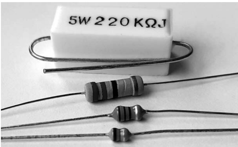
Rysunek 4.4. Im większy rezystor, tym większa powierzchnia chłodzenia i wyższa moc znamionowa
